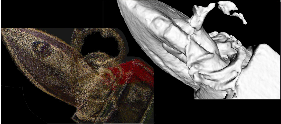
Obrázok 4.9: Naľavo sa nachádza výsledok registrácie žehličky, vpravo jej Poisson rekonštrukcia.
