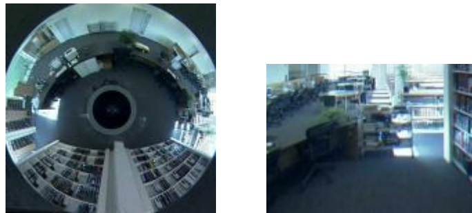
Obr32. Vľavo záber katadioptrickej kamery, vpravo projekcia do roviny pozorovateľa [03]
