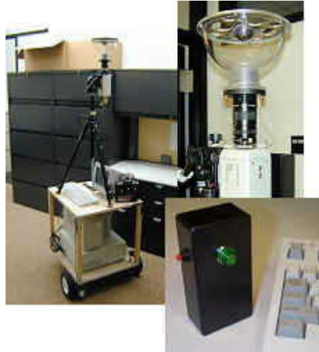
Obr31. Katadioptrická kamera na vozíku [03]
