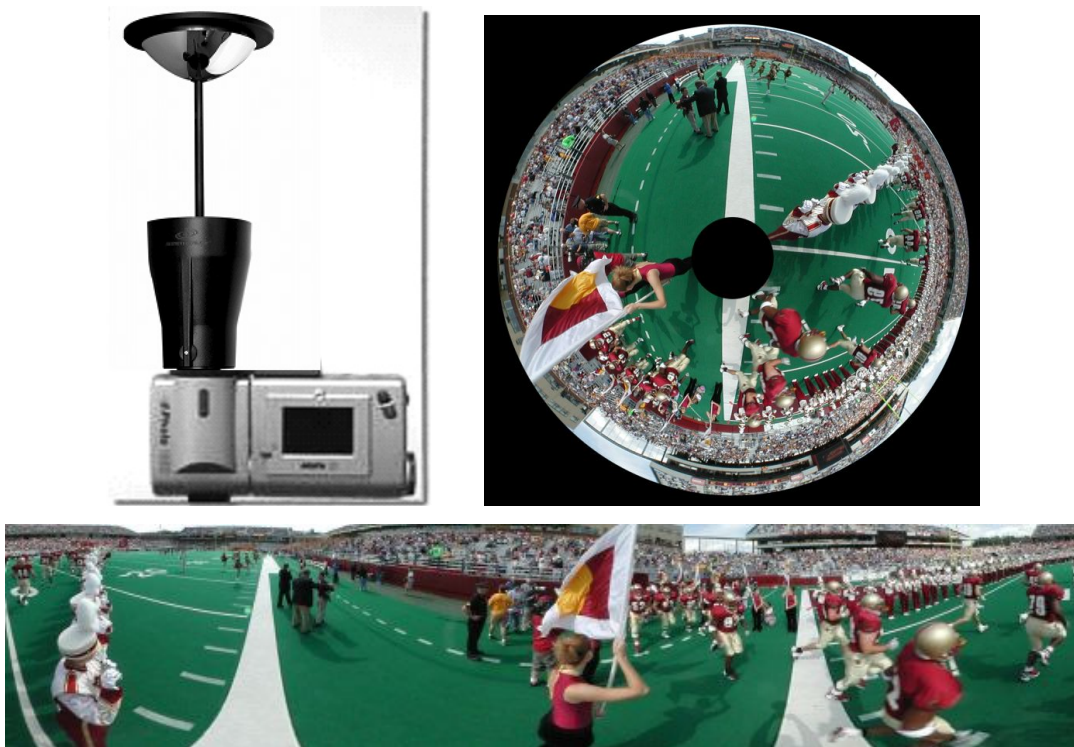
Obr19. Katadioptrická kamera, záber katadioptrickej kamery, transformovaná panoráma (dole) [26]
