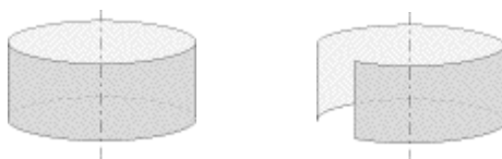
Obr16. Plná a čiastočná panoráma pri valcovej projekcii [24]
