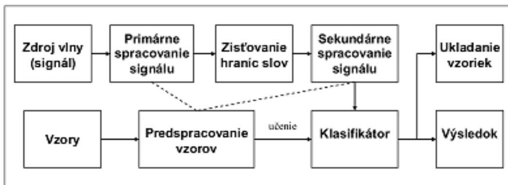
Obrázok 2.1: Architektúra automatického rozpoznávača izolovaných slov
