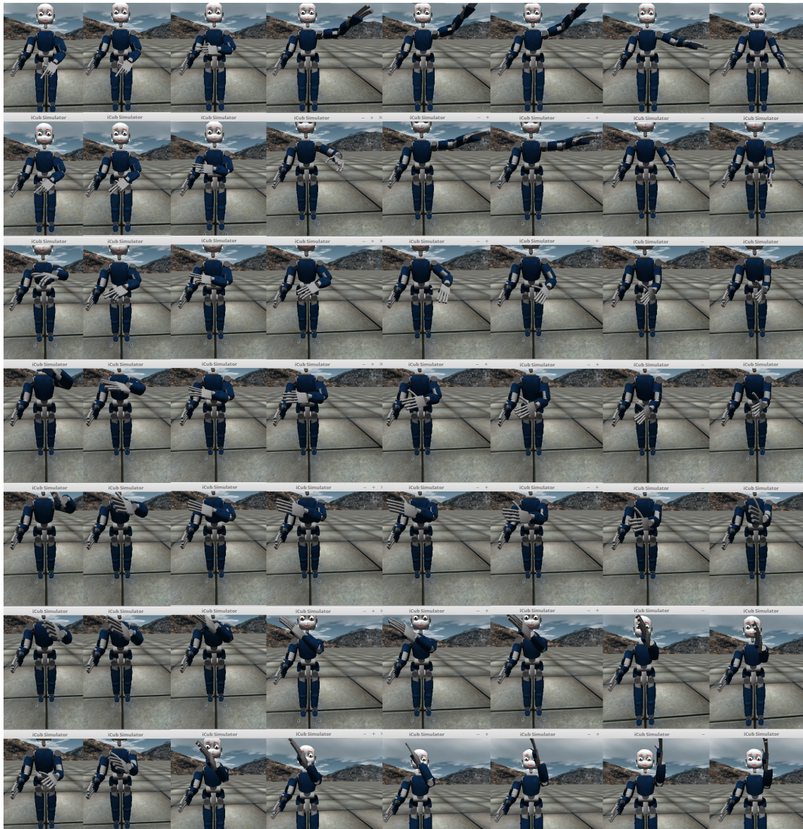
Obr. 6.2: Výsek 8 \times 8 neurónov natrénovanej SOM, so znázornením naučených póz ľavej ruky robota iCub. Zrejmá je topologická organizácia váh víťazov (reprezentujúcich preferované konfigurácie).
