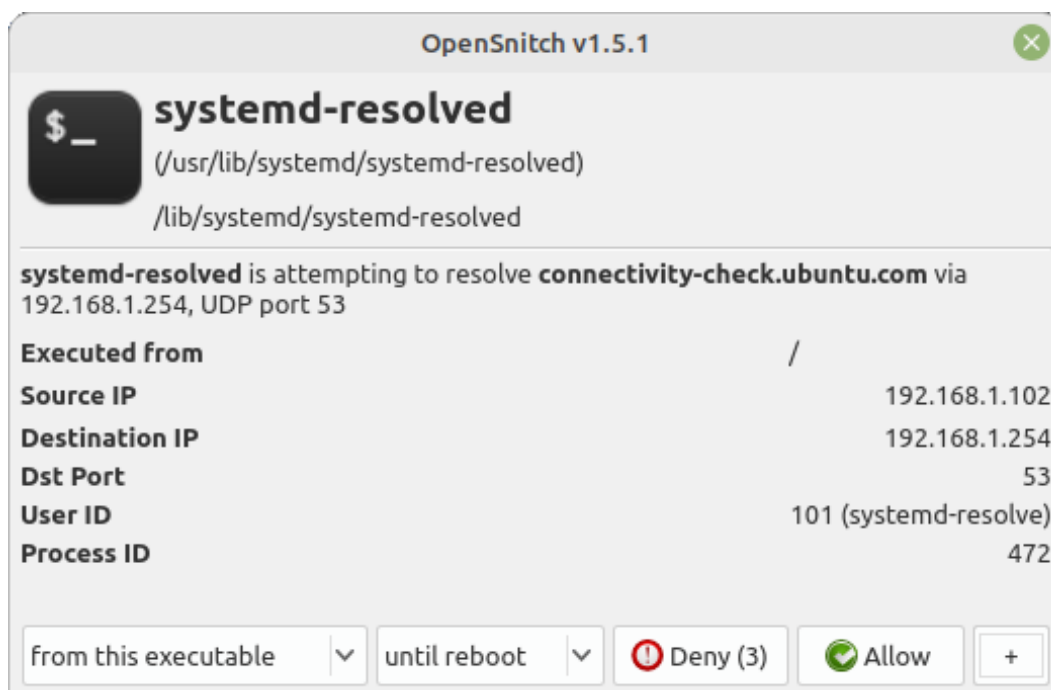
Obr. 4.3: Vyskakovacie okno OpenSnitchu. Môžeme si všimnúť, že oproti nášmu firewallu zobrazuje viac informácií aj dáva viac možností na vytvorenie pravidla
