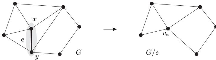
Fig. 1.7.1. Contracting the edge  $e = xy$
