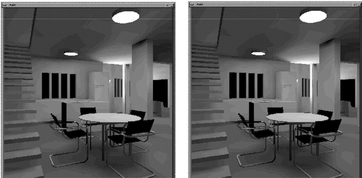
**Abbildung 12:** Mesh Decimation. Links: Gouraud-Schattierung des ursprünglichen Polygonnetz. Rechts: Gouraud-Schattierung des vereinfachten Polygonnetz (90% der Punkte wurden entfernt). Der visuelle Unterschied ist kaum betrachtbar.
